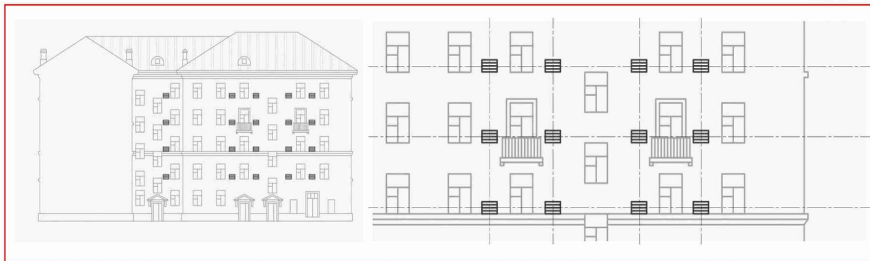
Пример правильного размещения кондиционеров на внутривором фасаде
