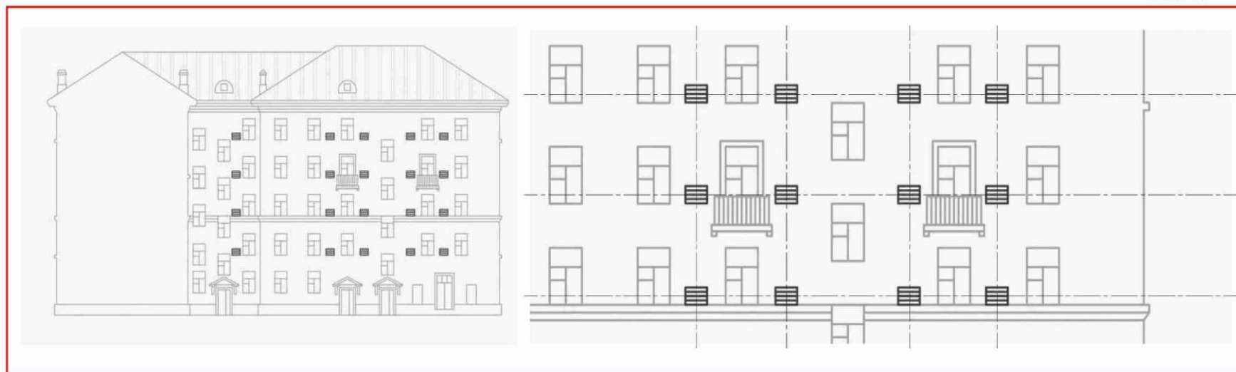
Пример правильного размещения кондиционеров на внутривором фасаде
